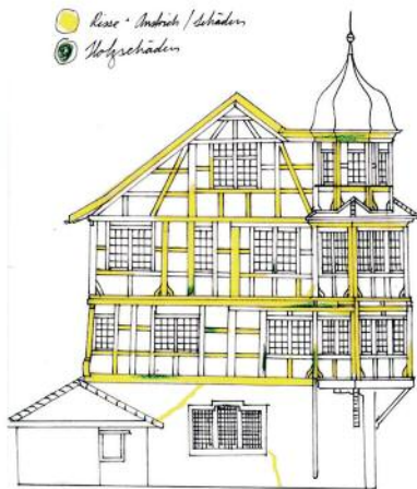
Eine Bestandesaufnahme durch Absolventen des Ausbildungslehrgangs Handwerk in der Denkmalpflege zeigt, dass nur wenige Holzteile Schäden aufweisen (grün), aber auf dem Riegelwerk der Farbanstrich dringend erneuert werden muss (gelb). Zudem sind im Verputz des Erdgeschosses verschiedene, jedoch nicht besorgniserregende Risse zu erkennen.
